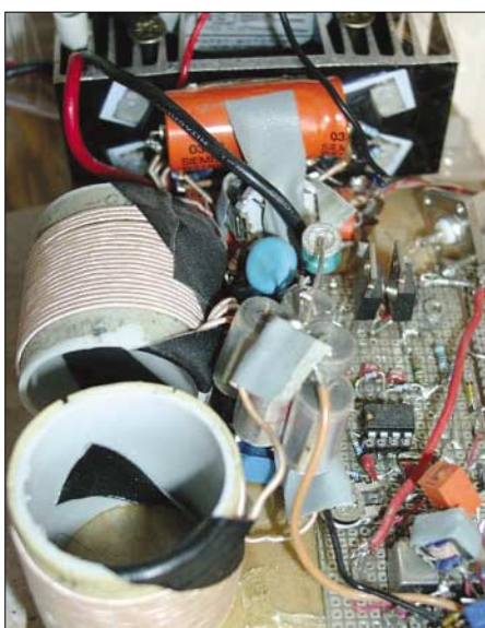
Liebvoller Aufbau der Station von DF6NM im sogenannten Küchenbrettaufbau
