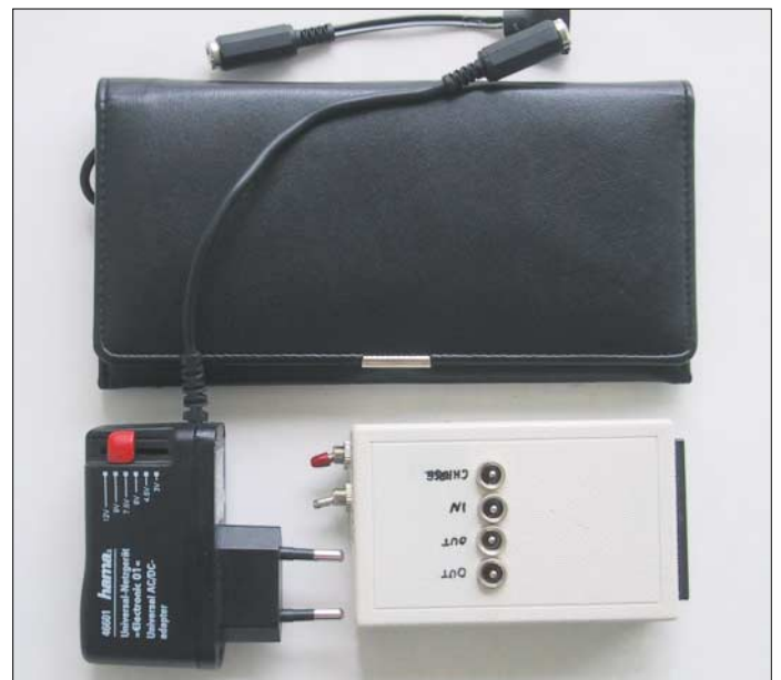
Bild 2: Als Ersatz für diverse Netzteile dient diese Reiseausrüstung bestehend aus Solarpaneel, Schaltnetzteil und Li-Ionen-Powerbox.
