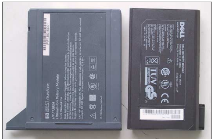
Bild 6: Verschiedene bei [1] ersteigerte Notebook-Akkumulatoren verdeutlichen die Weiterentwicklung – der große ist ein Backup-Akkumulator mit 2,7 Ah, der kleinere ein neueres Modell mit 3,8 Ah.
