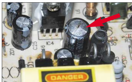
Bild 2: Heutige fernbedienbare Unterhaltungselektronik kennt keinen Netzschalter, das Netzteil läuft ständig durch. Nach zwei Jahren sind bei Billigplayern, wie hier beim Yamakawa 715, die überhitzten Elkos am Ende, sie platzen, blasen ihren Elektrolyt ab und trocknen aus ... Foto: DL2MCD
