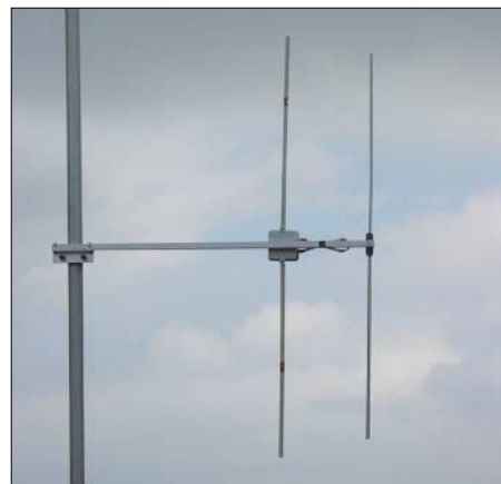
Bild 9: Ansicht der 2-Element-Yagi; das dritte Element wird durch den Mast gebildet Fotos: Autor
