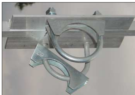
Bild 7: Selbstgebaute Masthalterung mit Winkel und Auspuffschellen
